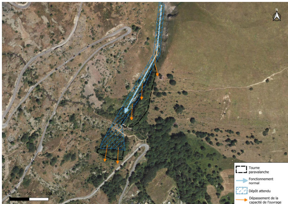
Figure 15 : Fonctionnement et dépassement de la tourne paravalanche
