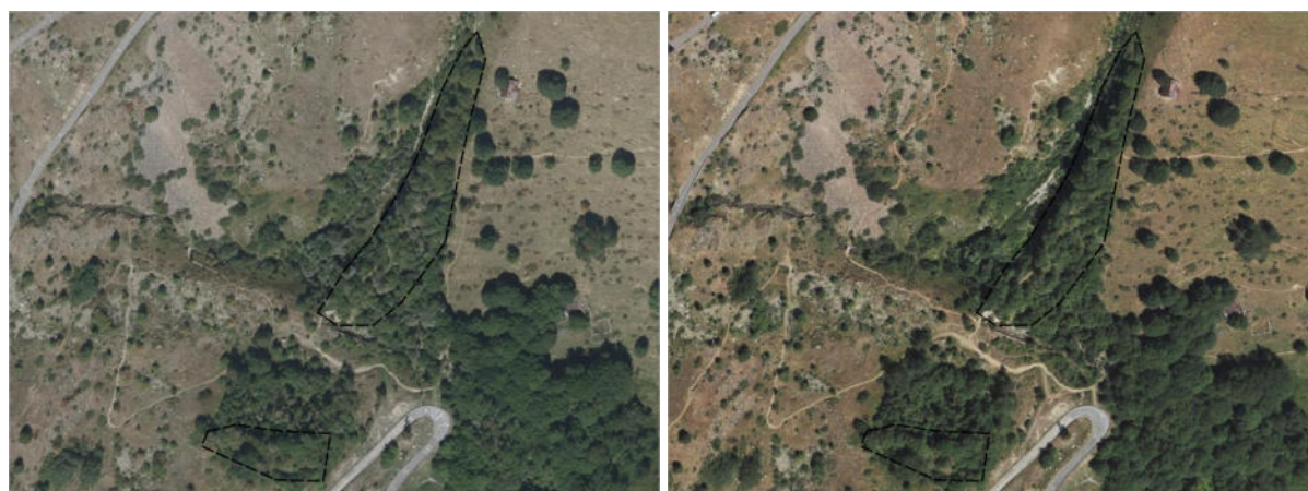
Figure 17 : Comparaison des photographies aériennes de 2016 (à gauche) et 2022 (à droite) mettant en évidence une trouée d'arbres arrachés et couchés dans la tourne paravalanche sur la photo la plus récente, témoignant du passage d'une avalanche.
