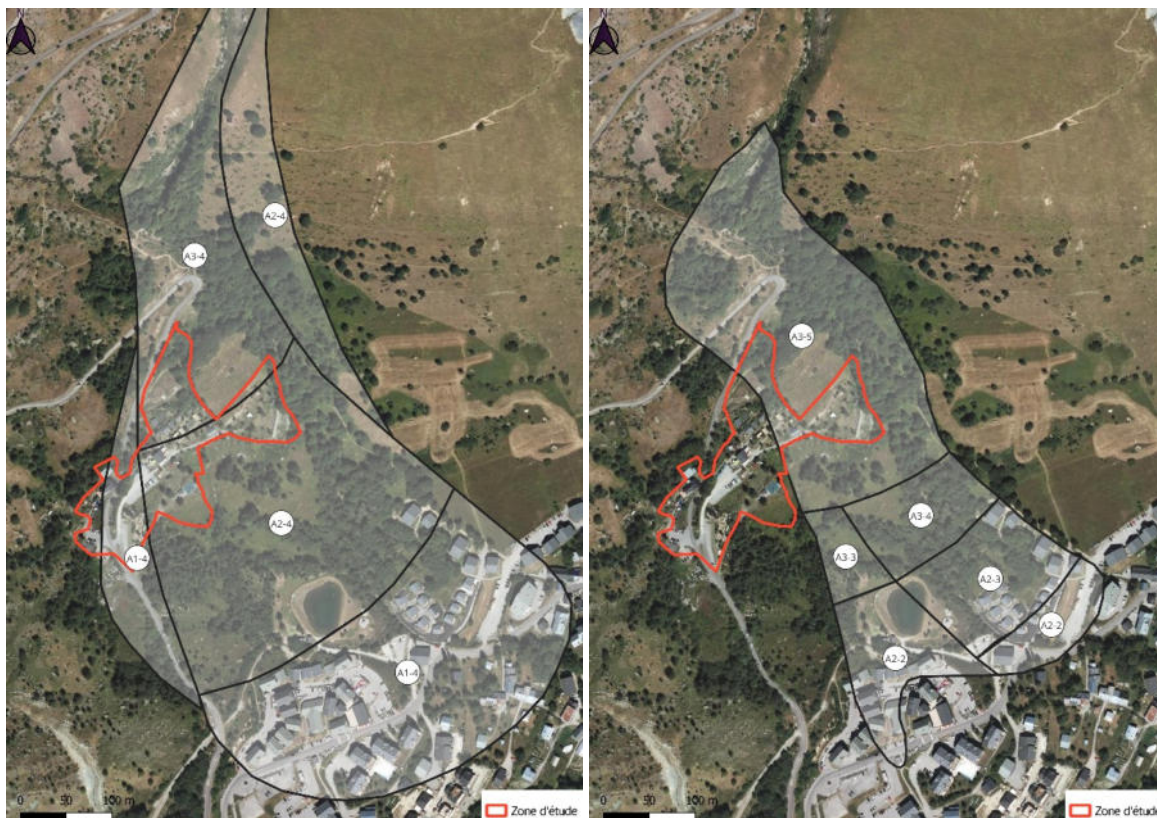
Figure 20 : Cartographie de l'aléa avalanche en provenance de la combe des Mortes d'après le PPR de 2003. Aérosol et écoulement dense.
