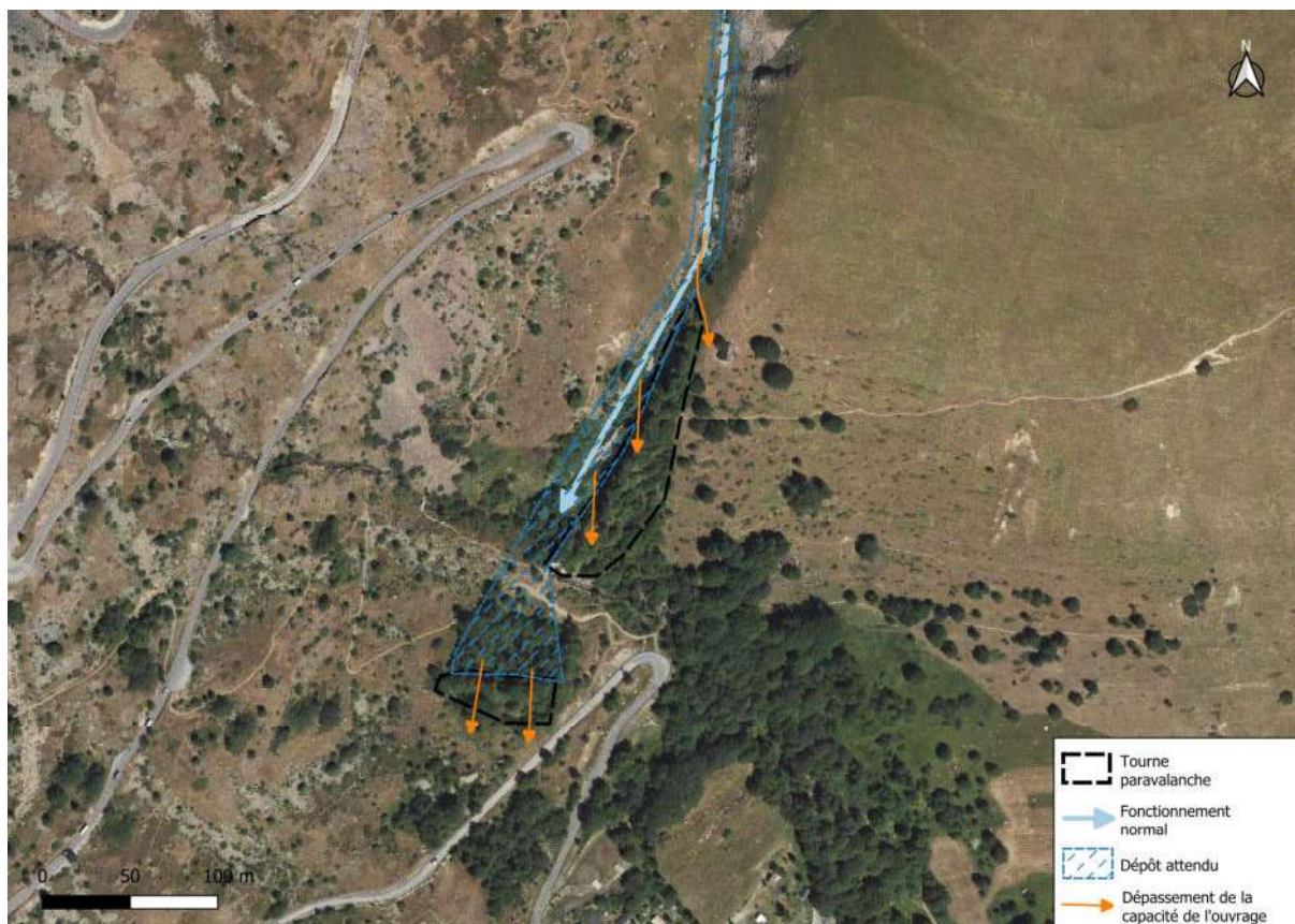
Figure 15 : Fonctionnement et dépassement de la tourne paravalanche
